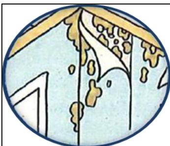
Des taches de moisissures apparaissent aux angles des murs extérieurs et des plafonds, derrière les meubles ou rideaux
